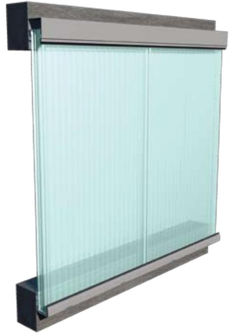
Mocowanie na zewnątrz ściany z profilem bez okapnika
